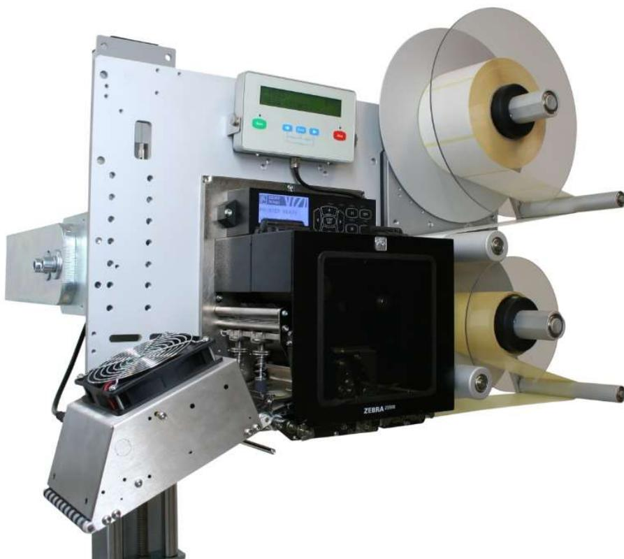
■ La **BL4050** ne nécessite pas d'air comprimé et s'adapte aisément à différents formats d'étiquettes sans modification de l'applicateur.
