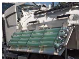
Support tube, dépliable hydrauliquement par radio
