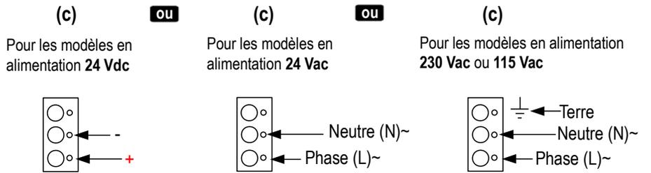
RACCORDEMENTS ELECTRIQUES – suivant normes NFC15-100
