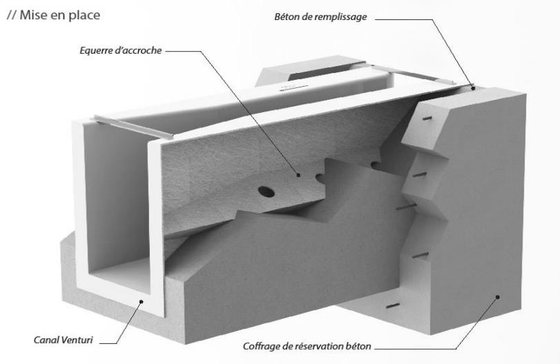
Prévoir un ouvrage d'accueil en béton afin d'intégrer le canal de niveau dans de bonnes conditions. Prévoir une réservation d'au moins **50 mm** de part et d'autre de la largeur et la hauteur hors tout du canal afin que le béton de remplissage s'intercale bien entre les bords supérieurs des canaux et le coffrage de réservation en béton.
