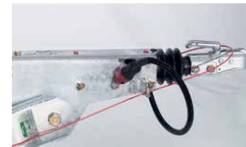
Dispositif d'attelage à boule pour timon réglable en hauteur
