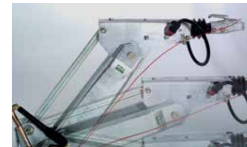
Timon réglable en hauteur (dispositif d'attelage à boule ou anneau DIN non compris)
