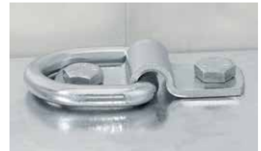
Anneaux de fixation supplémentaires sur surface de chargement
