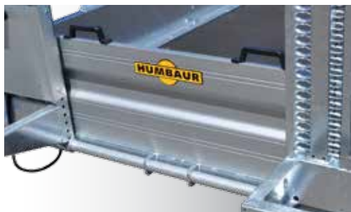
Paroi insérable en aluminium (devant les rampes)
