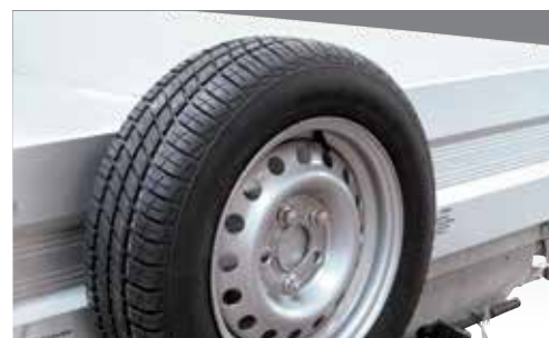
Support de roue de secours (monté)
