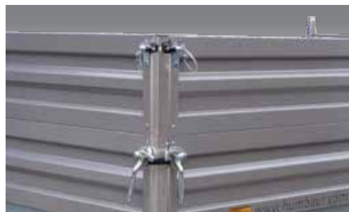
Rehausse de ridelle en acier de 350 mm, pendulaire en arrière
