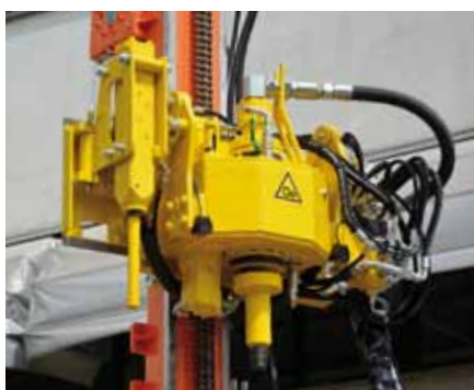
Testa di rotazione con martello a percussione Rotary head with hydraulic hammer Tête de rotation avec marteaux hydraulique Drehkopf bei hydraulii hämmer Cabeza de rotación con Martillo Hidráulico Головка вращения с ударным молотом
