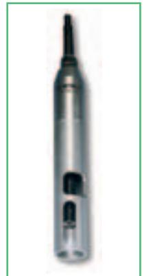
Cellule de mesure en profondeur TA 197 LF à 4 électrodes avec sonde de température intégrée et jusqu'à 100 m de câble, avec prise étanche (IP 67), protection en acier VA 1.4571 et capot de protection amovible, résistance à la pression 10 bar maxi, convenant pour des mesures en puits de 2".
