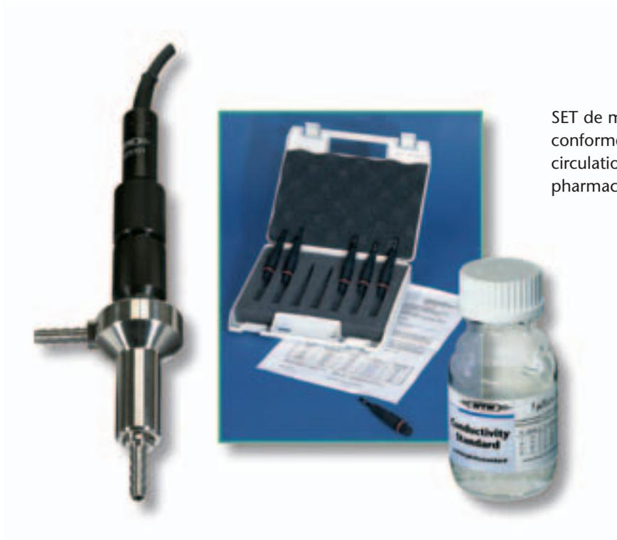
SET de mesure de la conductivité conforme à USP 28 avec cuve à circulation continue en inox pour eaux pharmaceutiques.
