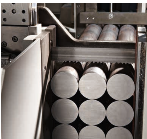
Dispositif hydraulique de serrage intégral pour coupes en paquet, côté aval.
