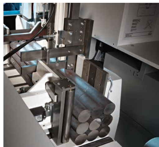
Dispositif hydraulique de serrage intégral pour coupes en paquet, côté amont.
