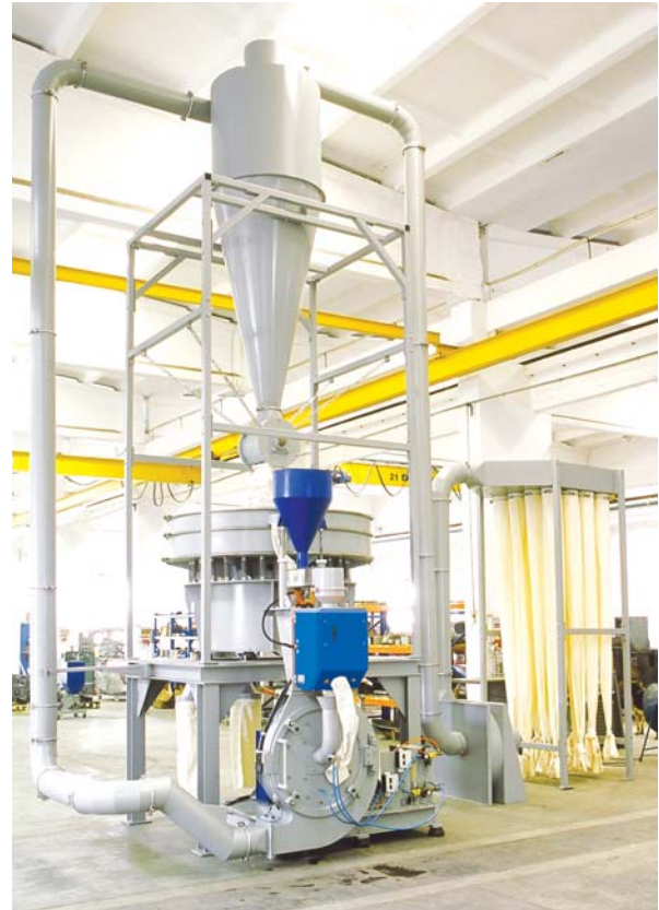
Ligne de micronisation comprenant PM 500, tamis vibrant & système d'aspiration
