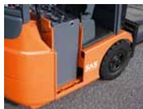
Remplacement de la batterie à basse hauteur.
