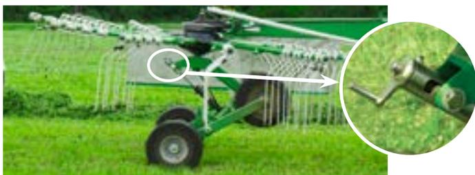
**B** Le système de suivi du terrain sur deux plans transversal **A** et longitudinal **B** permet un réglage indépendant des 2 rotors. Deux roues de suivi du sol en tandem et deux rotors indépendants garantissent un suivi parfait du terrain avec un ratissage très précis même à vitesse de travail élevée.
