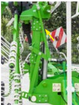
Réglage hydraulique de la largeur de ratissage en option (standard sur Z2-840).
