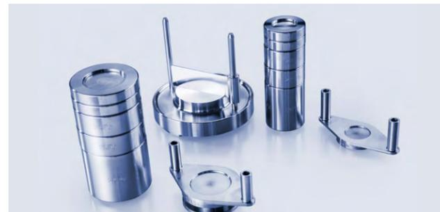
Banc et Masses pour petite et grande cellule de cisaillement pour la préparation sans bloquer votre dispositif
