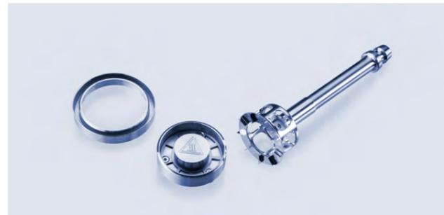
Petite cellule de cisaillement avec un volume de 4,3 mL pour petites particules, échantillons de valeur et charges standard élevées allant jusqu'à 30 kPa
