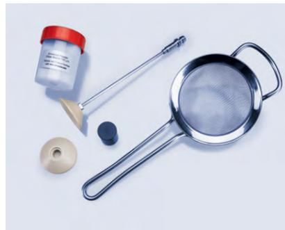
Méthode de mesure simple et sûre pour caractériser la masse volumique d'enveloppe des solides avec un échantillon allant de 0,3 cm<sup>3</sup> à 25 cm<sup>3</sup> en utilisant une poudre de déplacement très fluide. Une mesure précise du volume avec une répétabilité allant jusqu'à 1 % est assurée avec une quantité d'échantillon d'au moins 25 % du volume total de remplissage.
