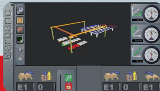
La commande du chargeur peut s'effectuer soit à partir de la scie à plat, soit sur un poste de commande propre à l'équipement. La commande sur écran tactile est conviviale et très simple d'utilisation.
