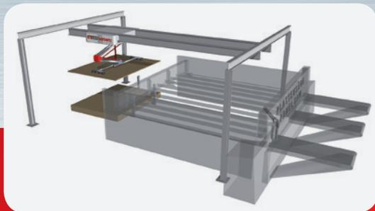
L'équipement est conçu modulairement, de manière à être adaptable aux dimensions de l'atelier, tout en offrant la possibilité d'optimiser le nombre des piles de panneaux.
