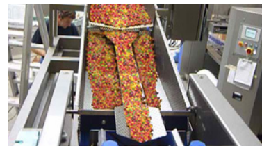
Remplissage en gros et fin sur la doseuse pondérale vibrante
