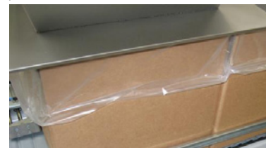
La machine est équipée d'un dispositif de maintien des sachets
