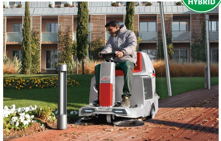
CS60 Hybrid travaille jusqu'à 7,5 heures sans jamais s'arrêter. Pendant que la balayeuse utilise le moteur à essence, les batteries se rechargent, de cette façon, il est possible de passer de l'alimentation à l'essence à l'alimentation électrique pour travailler en silence, de manière écologique et économique.
