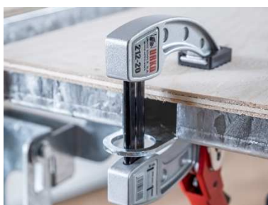
Maintien de la pièce à découper à l'aide des serre-joints
