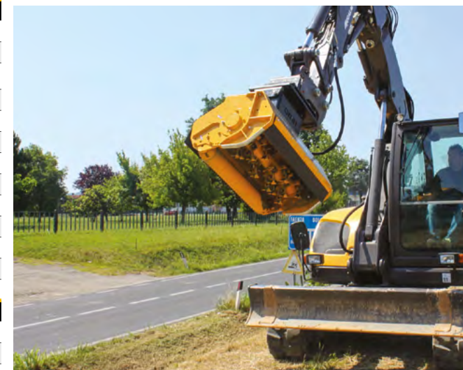
T ROTOR SEMI-FORESTIER AVEC MARTEAUX ROTATIFS A: Ø 235 x 5mm
