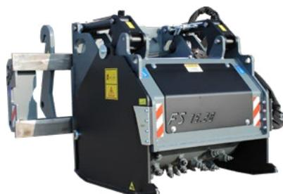
La raboteuse a la fonction de démanteler les croûtes du revêtement routier, le ciment des aires de stationnement, de gratter la roche ou simplement de créer des passages ou traces où il y a l'asphalte. Produite en 8 modèles avec des largeurs de 25 à 100 cm, elle peut être appliquée à mini chargeurs, tractopelle et chargeurs sur pneus hydrostatiques.
