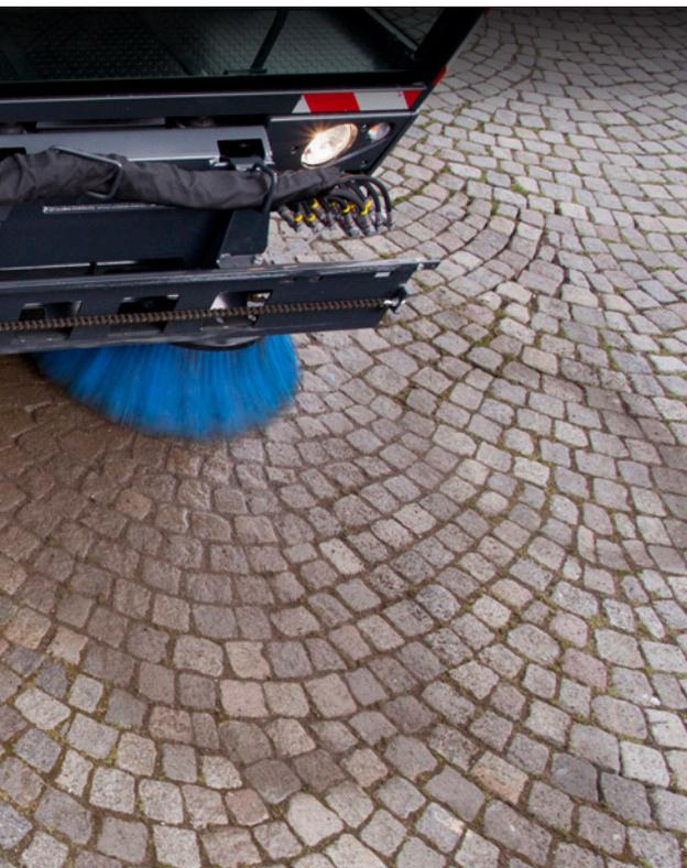
Avec la commande indépendante de brosses en option, l'inclinaison des brosses rotatives peut être adaptée de manière hydraulique aux caractéristiques de la chaussée à partir de la cabine. De même, la pression au sol des brosses rotatives peut être réglée séparément à droite et à gauche à partir de la cabine. Ainsi, le balayage propre de coins à angle droit, de caniveaux et d'endroits difficiles à atteindre est encore plus confortable.
