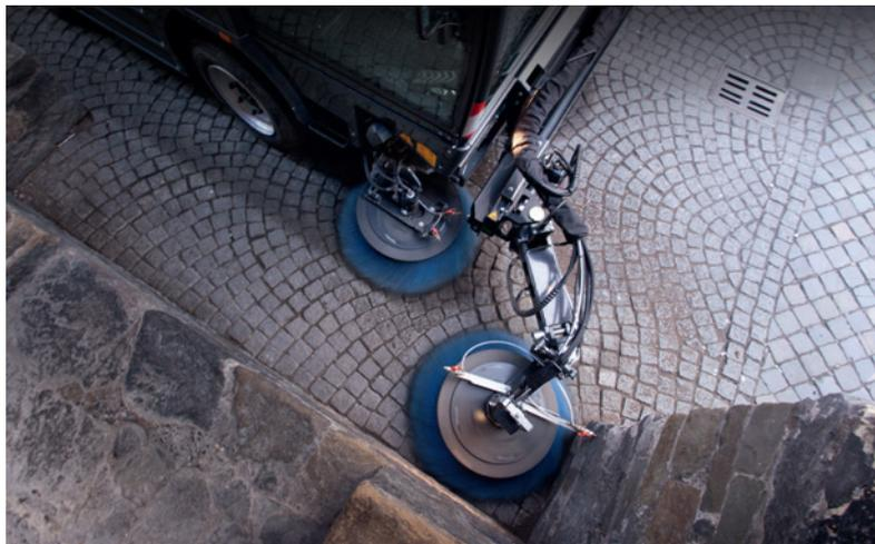
Le bras robuste avec la brosse frontale peut être utilisé aussi bien sur le **côté gauche que sur le côté droit** de la machine et est de plus adapté à l'utilisation pour les mauvaises herbes tenaces. Toutes les fonctions de la brosse frontale sont commandées de manière hydraulique, y compris la pression d'appui de balai.
