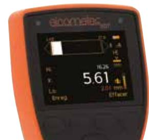
En mode Scan, la jauge prend des mesures à un taux de 16 Hz (16 mesures par seconde).
