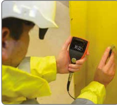
Ces jauges possèdent toutes les caractéristiques et fonctions nécessaires pour mesurer l'épaisseur et la vélocité sur presque tous les matériaux dans divers domaines d'application.
