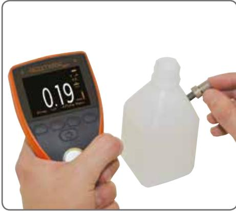
La gamme de jauges d'épaisseur par ultrasons PTG est précise à  $\pm 1\%$  de 0.15 mm (0.006") à 25.40 mm (1.000").
