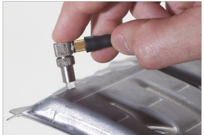
Mesure de l'amincissement du métal causé par le pliage ou le formage
