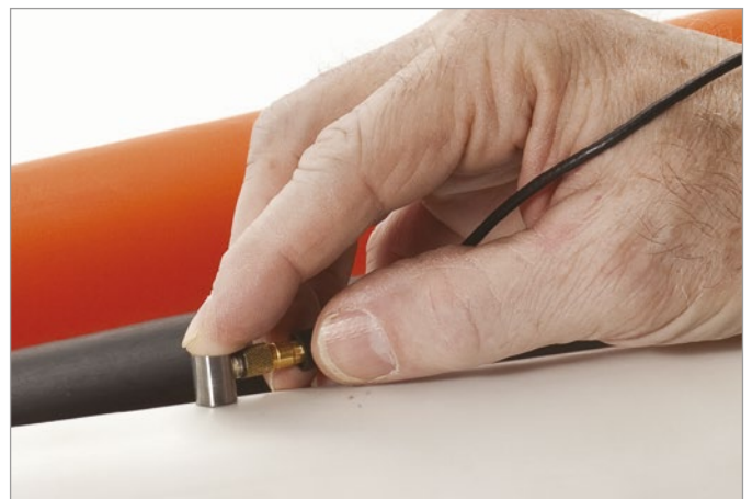
Mesure de l'épaisseur de nombreux matériaux incluant le plastique, le caoutchouc, le verre, la céramique et les composites
