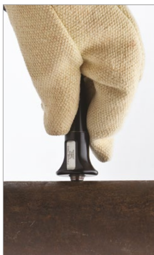
Sonde D790-SM sur un tube à haute température
