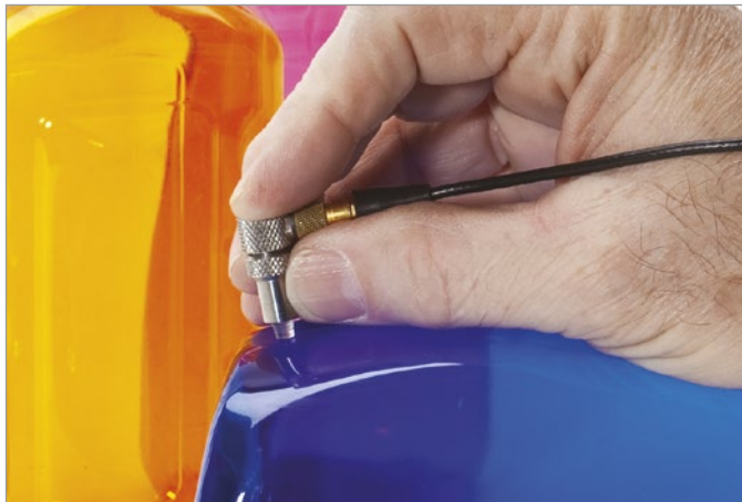
Mesure d'un matériau plastique mince à l'aide d'une sonde à lignes à retard de 20 MHz
