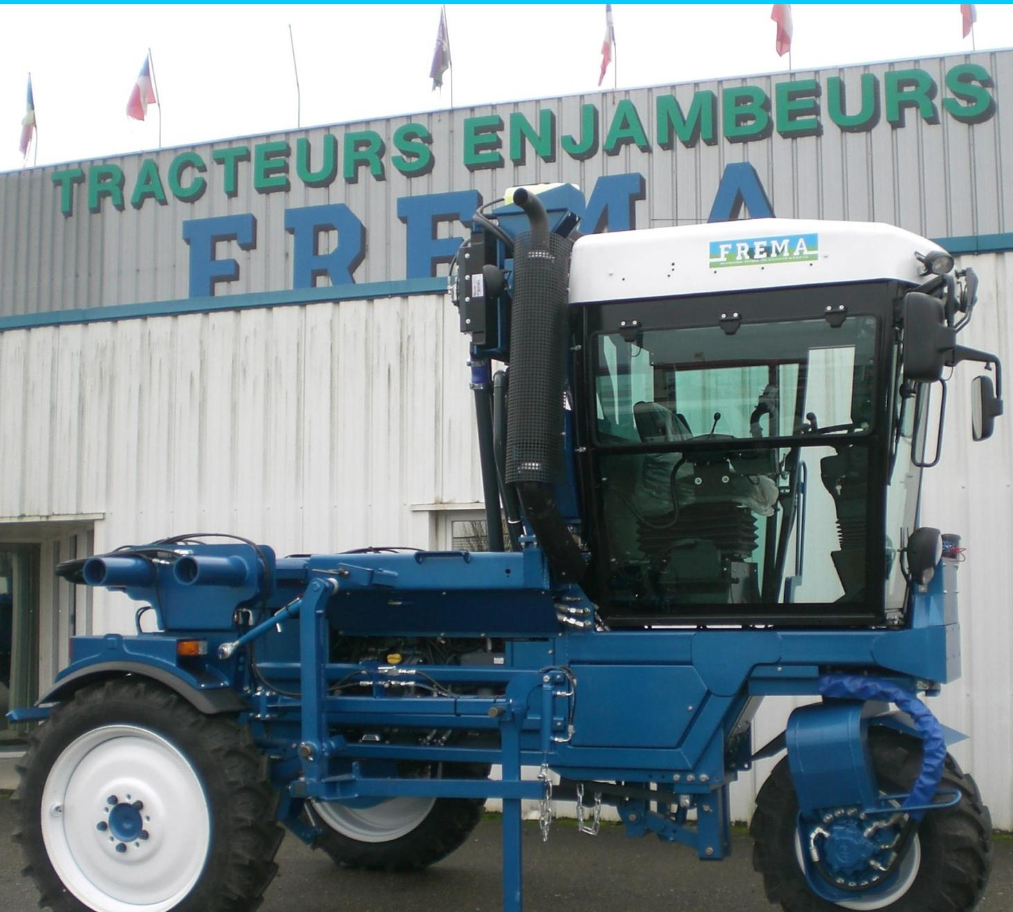
**Suspension hydraulique sur roue à l'avant (système breveté)**
