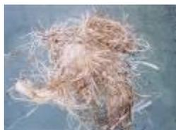
Absorbant sous forme de spaghetti de 7-8 cm de longueur et 1,5 à 2 mm de diamètre, enchevêtrés pour filtrer les huiles et les hydrocarbures dans l'eau et les solutions aqueuses. Les liquides, vapeurs et gaz circulant facilement au travers des ouvertures et des passages laissés libres entre les bandes de spaghetti sont néanmoins vrillés à l'intérieur favorisant encore plus la rétention des produits hydrocarbures.
