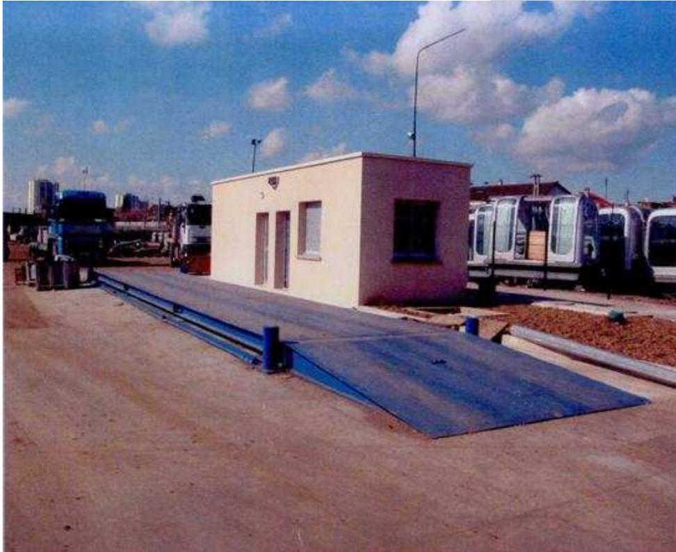
Entièrement métallique, le pont bascule de type **GMO** a été conçu pour répondre aux utilisations les plus dures en matière de pesage de véhicule routier et ce quel que soit le secteur d'activité.
