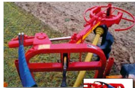
La tarière BPO 1000 équipée du déport de grande amplitude permet le forage de trous jusqu'à 1,05 m à droite ou gauche de l'axe du tracteur, soit un écartement de 2,10 m au total. Le déport évite toutes manœuvres difficiles du tracteur et facilite l'alignement des trous. Châssis robuste réalisé en profilés soudés. Attelage catégorie I et II. Béquilles de remisage escamotables.
