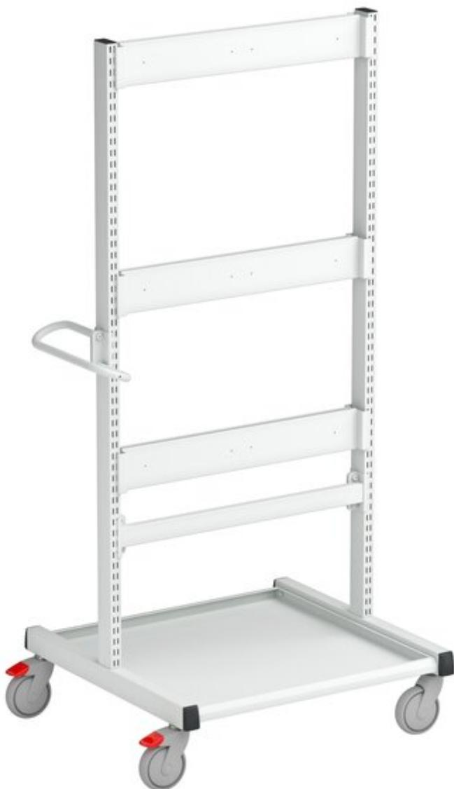
Chariot ESD pour armoires de rangements de petits composants. Le chariot permet de supporter 8 armoires ESD qui doivent être commandées séparément. Ce chariot ESD double face dispose de 4 roues ESD pivotantes de 100mm dont deux sont équipées de freins. Une étagère basse fait partie de la structure standard ainsi qu'une poignée de manutention réglable en hauteur qui permet de déplacer aisément la desserte.
