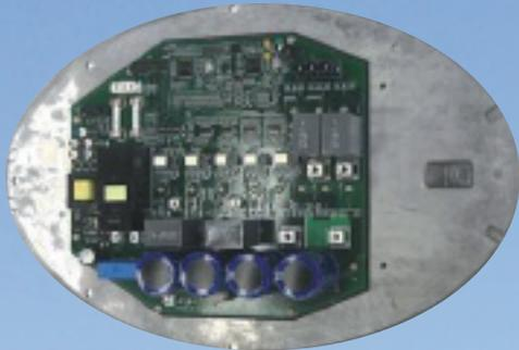
L'onduleur fait partie intégrante de la coque de la nacelle moulée en aluminium (breveté) afin d'optimiser la dissipation thermique, de simplifier l'installation et de réduire les coûts de fabrication.
