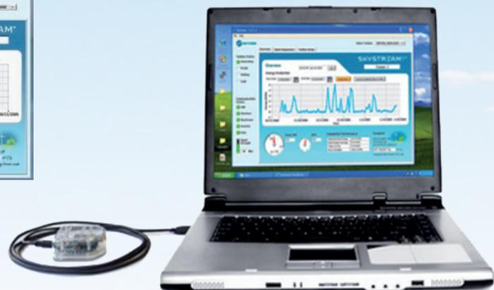
Une liaison sans fil (ZigBee) permet de communiquer en temps réel avec un PC et de présenter l'ensemble des paramètres de fonctionnement et de performance de la Skystream. Le logiciel SkyView fourni l'accès aux données détaillées de votre production journalière ainsi qu'aux données historiques.
