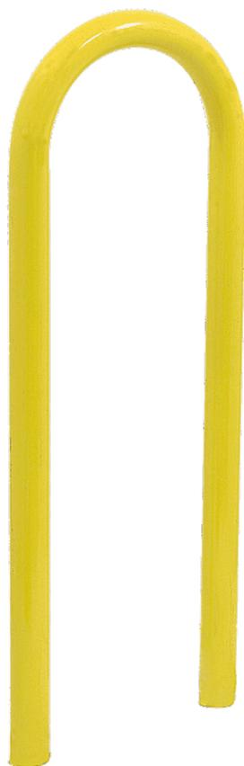
Borne fabriquée en tube en acier galvanisé avec traitement Ferrus, procédé qui protège le fer et garantit une résistance optimale à la corrosion. Le traitement Ferrus consiste en trois couches appliquées à la suite du nettoyage de toutes les impuretés par grenailage : zingage, couche époxy et une couche de peinture poudre polyester coloris jaune RAL 1021.
