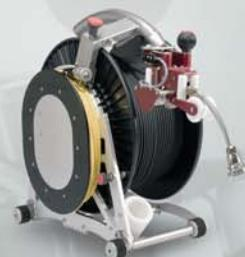
**Avec la plate-forme numérique de contrôle en réseau PipeBus, SuperVision utilise un câble plus léger. De part sa haute technologie, le système SuperVision, peut exécuter en parallèle plusieurs tâches (Gestion de différents chariots et touret de câble).**
