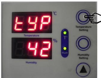
Menu « Typ »: Choisissez « C » pour refroidissement (cooling) ou « H » pour chauffage (heating).
