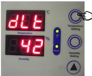
Menu « dLt »: Ce menu permet de régler un temps minimum entre le moment où le relai se coupe, et le moment où il se rallume. Il permet d'éviter les cycle court et ainsi de protéger vos appareils.
