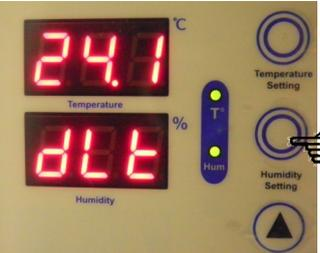
Ce menu permet de régler un temps Minimum entre le moment où le relai se coupe, et le moment où il se rallume. Il permet d'éviter les cycles courts et ainsi de protéger vos appareils.
