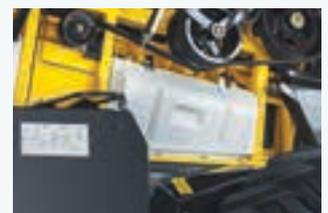
Les couvercles d'accès aux rotors en matière plastique, peuvent être déposés sans outil.
