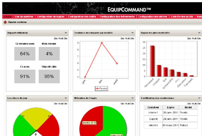
La récupération des données se réalise à l'aide d'une clé Dallas, d'une borne radio (modèle RF) ou d'un point d'accès wifi. Le logiciel, très simple d'utilisation, permet de lire la date et l'heure des 400 derniers chocs et/ou utilisateurs. Ce même logiciel permet de programmer chaque clé personnelle nécessaire à chaque cariste pour démarrer son chariot.
