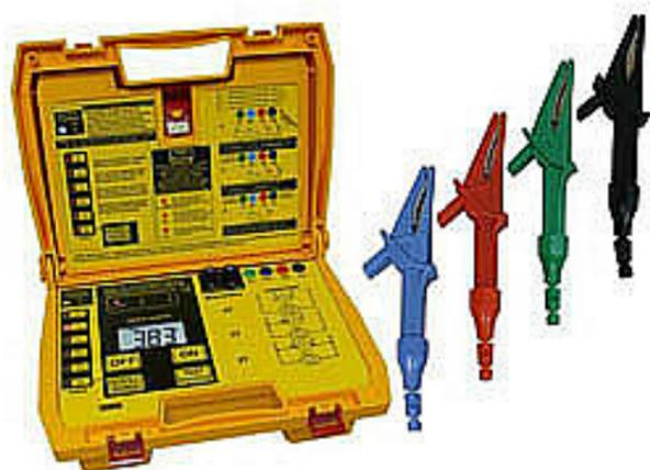
**Résolution jusqu'à  $1\mu\Omega$  / carcasse robuste / grand écran LCD / fonctionnement par accumulateur/ contrôle interne de température / console de commande simple / méthode de mesure à 4 conduits**
