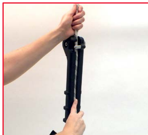
4. Logez la corde dans la potence de guidage
