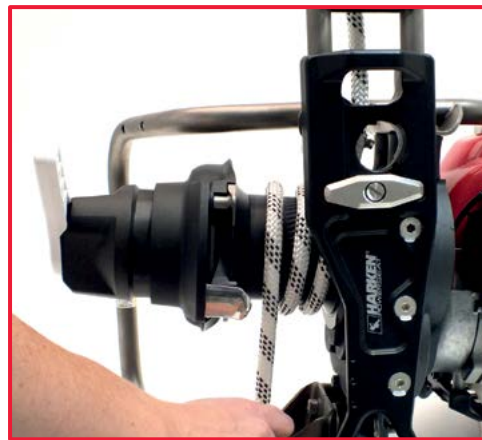
8. Enroulez la corde autour du tambour du treuil dans le sens des aiguilles d'une montre
