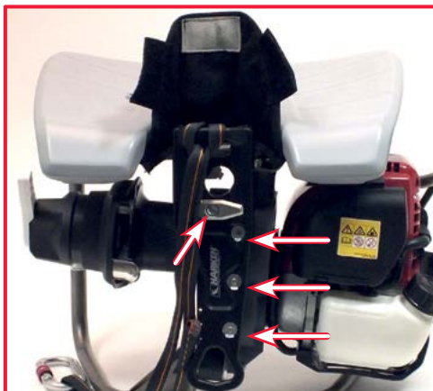
Contrôlez toutes les vis et vérifiez que le repère qui indique la position des vis n'a pas subi d'altérations qui pourraient indiquer une modification du serrage de ces vis. En cas d'anomalie, contactez un centre d'assistance HARKEN.
