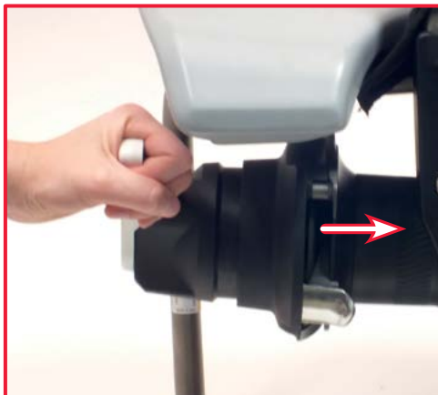
Vérifiez le fonctionnement du levier de contrôle des semi-poulies en le tournant et en le relâchant (SEMI-POULIE FERMÉE).
