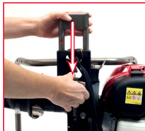
4. Tirez sur le dispositif de blocage et insérez la potence de guidage dans son logement.
