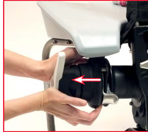
Vérifiez le mouvement du couvercle des semi-poulies.
