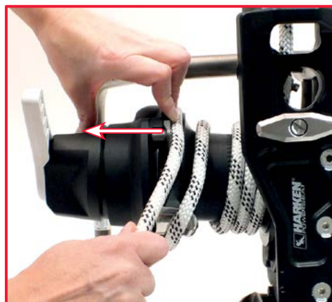
10. Faites passer la corde entre les deux semi-poulies. Pour faciliter l'opération, soulevez le couvercle
