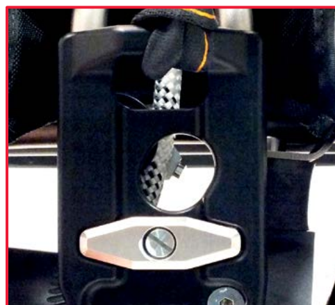
6. Vérifiez que la corde a été correctement insérée dans son logement
