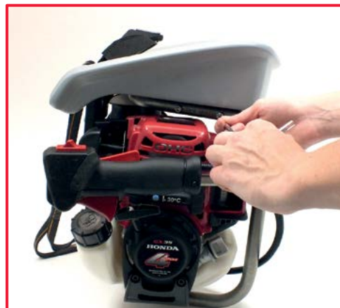
2. Dévissez les 4 vis qui fixent le siège au châssis en utilisant une clé Allen n° 5.
