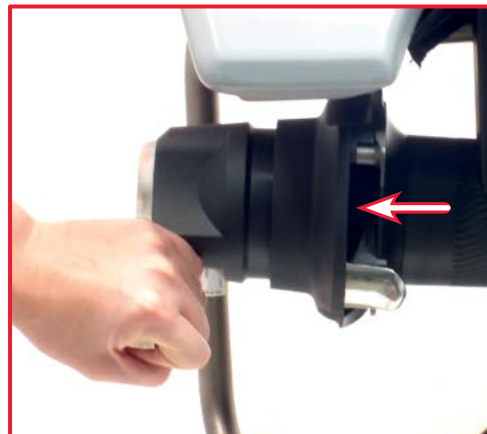
Vérifiez le fonctionnement du levier de contrôle des semi-poulies en le tournant et en le relâchant (SEMI-POULIE OUVERTE).
