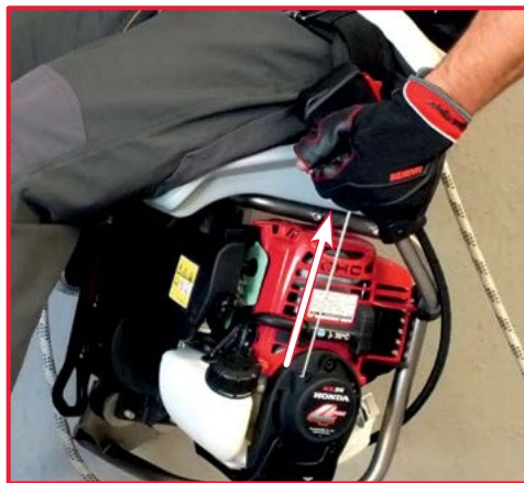
7. Tirez sur la corde du lanceur pour faire démarrer le moteur
