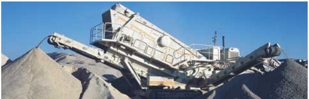
Le crible DS à trois étages du Lokotrack ST620 est spécialement conçu pour applications mobiles.
