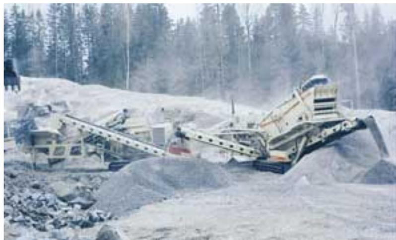
*Le Lokotrack ST620 associé à un groupe mobile de concassage secondaire LT300HP.*
