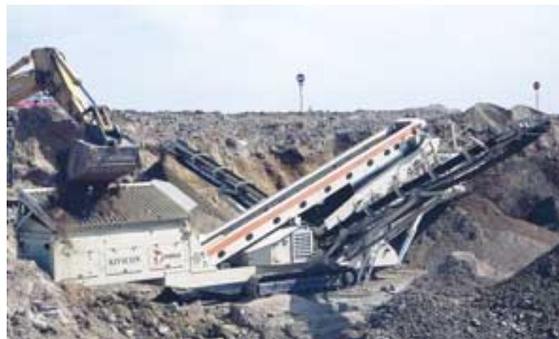
*La construction modulaire du Lokotrack ST352 assure la rapidité et la facilité de sa maintenance.*
