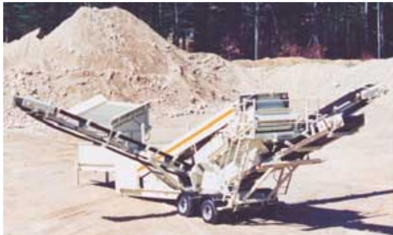
*La plate-forme de service assure un accès aisé aux panneaux du crible pour le remplacement de la toile.*
