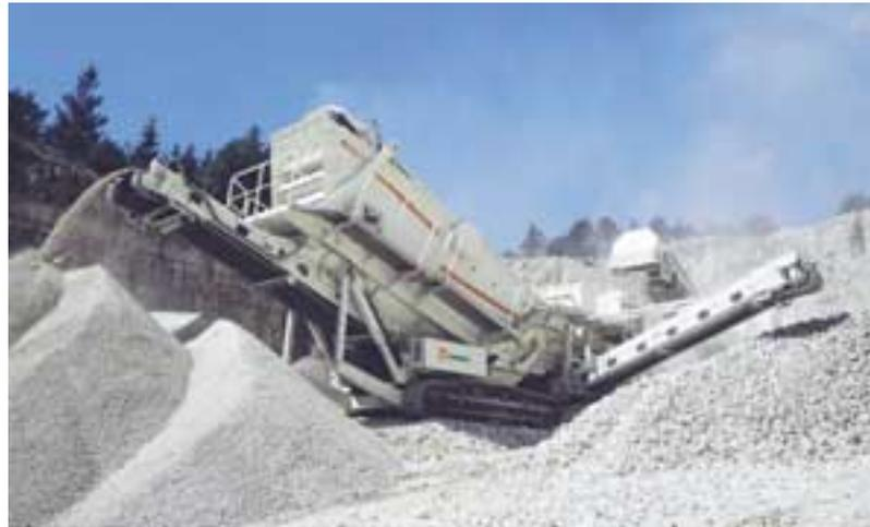
*Ensemble mobile complet de concassage et criblage comprenant un Lokotrack LT1415 et un ST620.*
