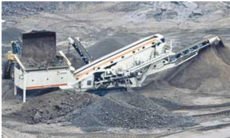
*Les blocages de matériaux sont évités par un dispositif de réglage hydraulique à trois positions de la molette.*
