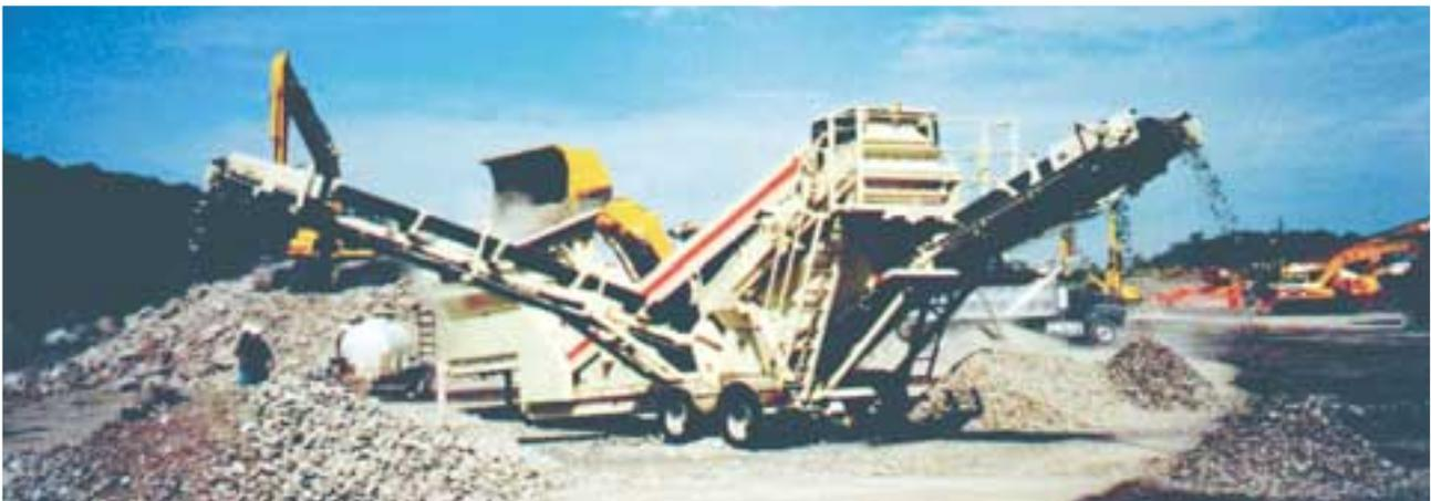
Les transporteurs de décharge et de produit embarqués du Nordberg SW348, rapides à mettre en service, éliminent le besoin de transporteurs de stockage séparés.
