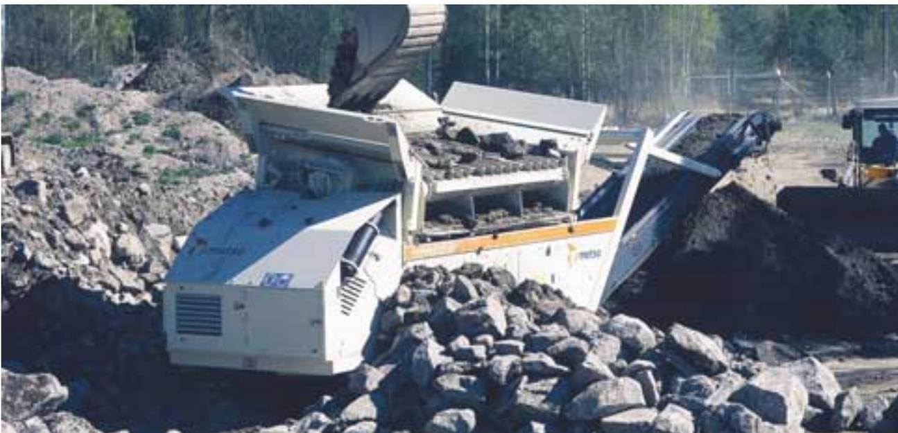
La possibilité d'inverser le sens de rotation du mécanisme de la grille vibrante du Lokotrack ST171 permet de maximiser l'efficacité du criblage avec les différents matériaux difficiles.
