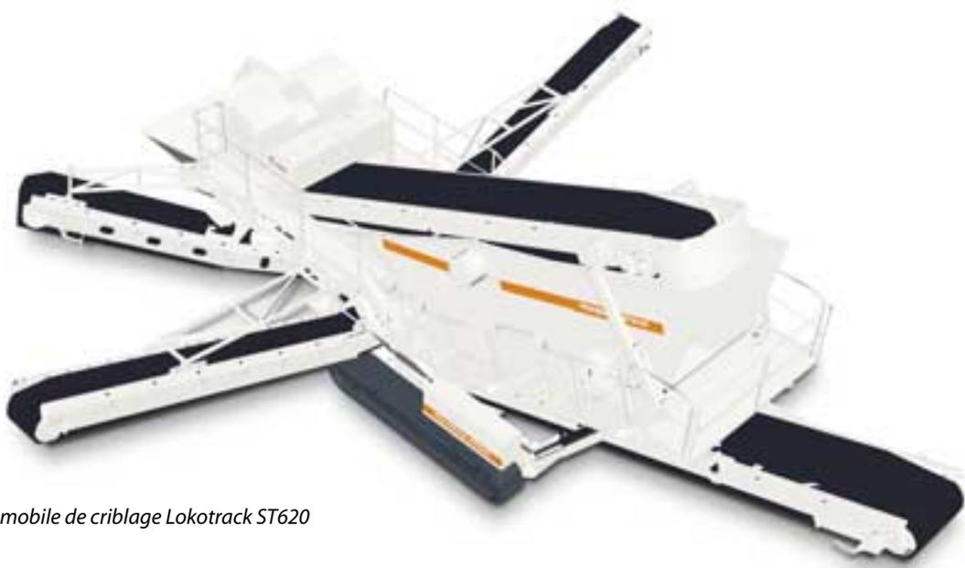
Groupe mobile de criblage Lokotrack ST620
