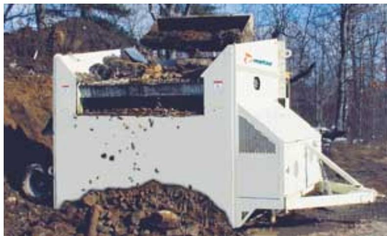
*La grille vibrante interchangeable du Nordberg CV50 peut s'utiliser avec toile de crible, tôle perforée, barreaux, grille harpée ou grille à doigts.*
