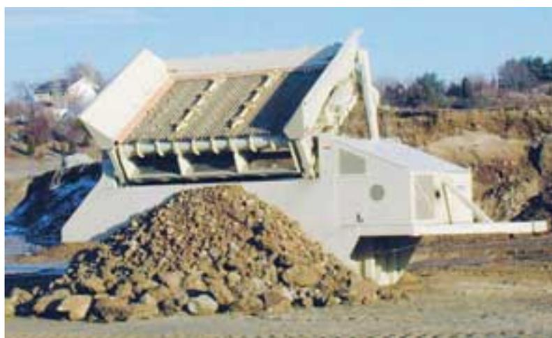
*Un dispositif de basculement télécommandé de la grille permet, en standard sur le Nordberg CV100, d'éliminer les matériaux éventuellement indésirables.*
