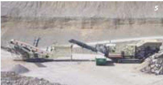
Figure 1 : Groupe mobile de concassage LT105 et groupe mobile de criblage ST356 – Italie
