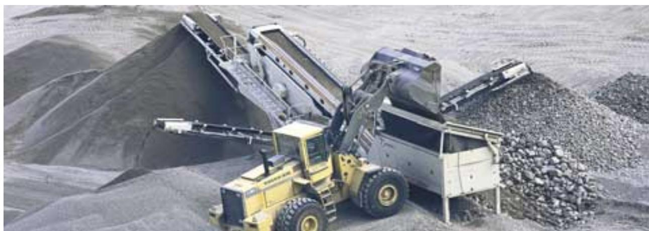
Le groupe mobile de criblage Lokotrack ST356 possède l'alimentateur à bande ayant la plus grande capacité du marché.
