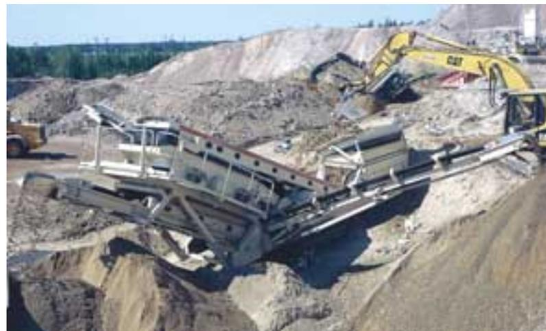
*Le Lokotrack ST352 avec un système à alimentation directe dans le cas où l'alimentateur vibrant et le transporteur d'alimentation sont inutiles.*
