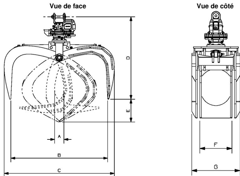
OPTIONS: Tapeur. Couteau pour fermer la mâchoire large. Protection pour les billots, incluant barre ronde sur les pointes et lanières de protection à l'intérieur des mâchoires. Pointes des mâchoires modifiées pour éviter d'endommager les billots. Soupape de protection contre les impacts disponible sur certains modèles (vérifier avec l'usine).
