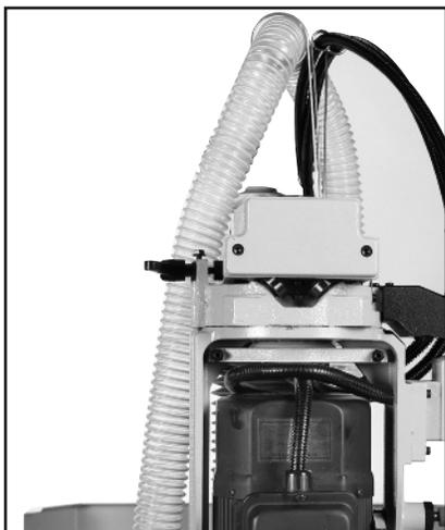
2. A l'aide d'un bloc de référence, manoeuvrer le volant de réglage de la hauteur jusqu'à ce que le bout de l'arbre moteur vienne effleurer le bloc de référence. Verrouiller cette hauteur, car elle servira de référence.
