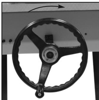
6. Arrêter le moteur et attendre que la lame s'immobilise. Mémoriser l'emplacement de la poignée du volant, remonter la lame, dégager le chariot et mesurer la profondeur du trait de scie réalisé. Si la profondeur n'est pas suffisante, refaire les étapes précédentes.
