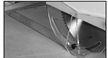
5. Tout en maintenant l'équerre contre le guide, faire coulisser le chariot jusqu'à la colonne. La lame ne doit ni pousser l'équerre ni s'en éloigner. Si un réglage est nécessaire, tapoter légèrement la table pour la faire pivoter du jeu nécessaire.
