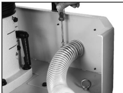
3. Glisser ensuite l'autre extrémité du tuyau dans l'ouverture du support de broche. Fixer le support à la verticale à l'aide de la vis à tête cylindrique.
