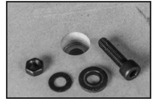
3. Assembler la table au bâti de la machine, mais sans trop serrer les quatre vis à tête cylindrique.
