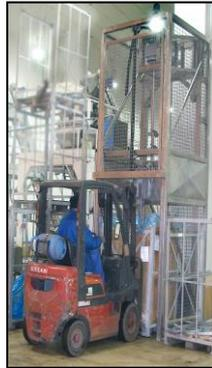
L'emballage ouvert est introduit dans la chambre à l'aide d'un élévateur à fourche. Après la mise en marche de l'équipement une grille de protection se ferme automatiquement et ensuite le foret commence à tourner en enfonçant les "doigts" dans le produit surgelé. Un conducteur à microprocesseur règle la vitesse d'enfoncement et le temps de travail du foret. A la fin du processus la grille se lève automatiquement. Le foret et la grille sont entrainés à l'aide d'un système hydraulique.
