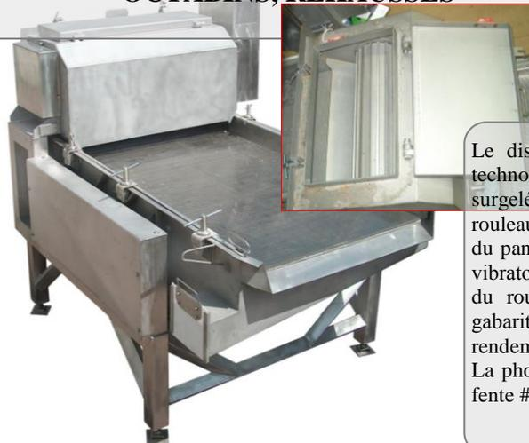
Le dispositif du broyage fonctionne sur la ligne technologique de trie optique et d'emballage des surgelés. Le produit est administré au-dessous du rouleaux de broyeur à l'aide de convoyeur vibratoire du panier tampon et ensuite il est passé par le tamis vibratoire à fentes. La vitesse rotative et la distance du rouleau de la paroi - réglés en continu. Les gabarits et la puissance de l'équipement dépendent du rendement.
