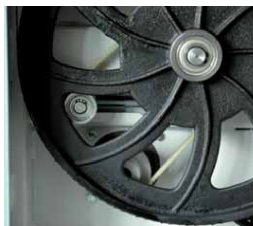
Volants en fonte d'acier équilibrés 2 vitesses de coupe
