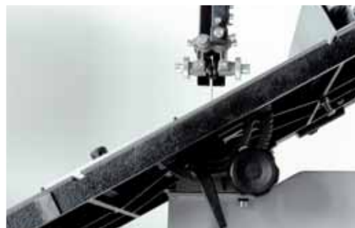
Guide de lame supérieur et inférieur à galets
