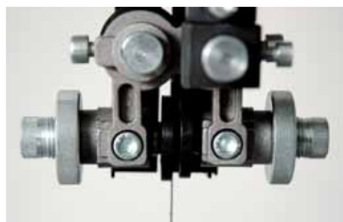
Guide de lame supérieur et inférieur à galets
