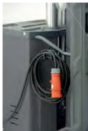
Rangement pour le câble électrique
