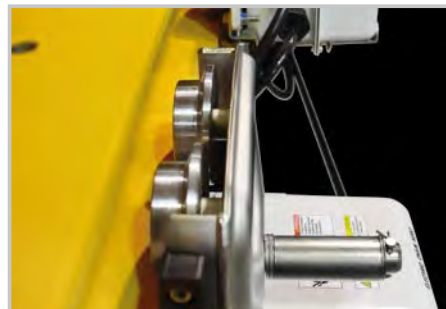
Galets des deux chariots en acier inoxydable
