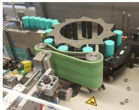
Bande massante permettant le lissage de l'étiquette autour du flacon
