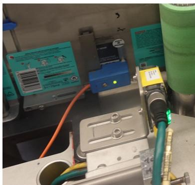
Contrôle du code Datamatrix par caméra (options)
