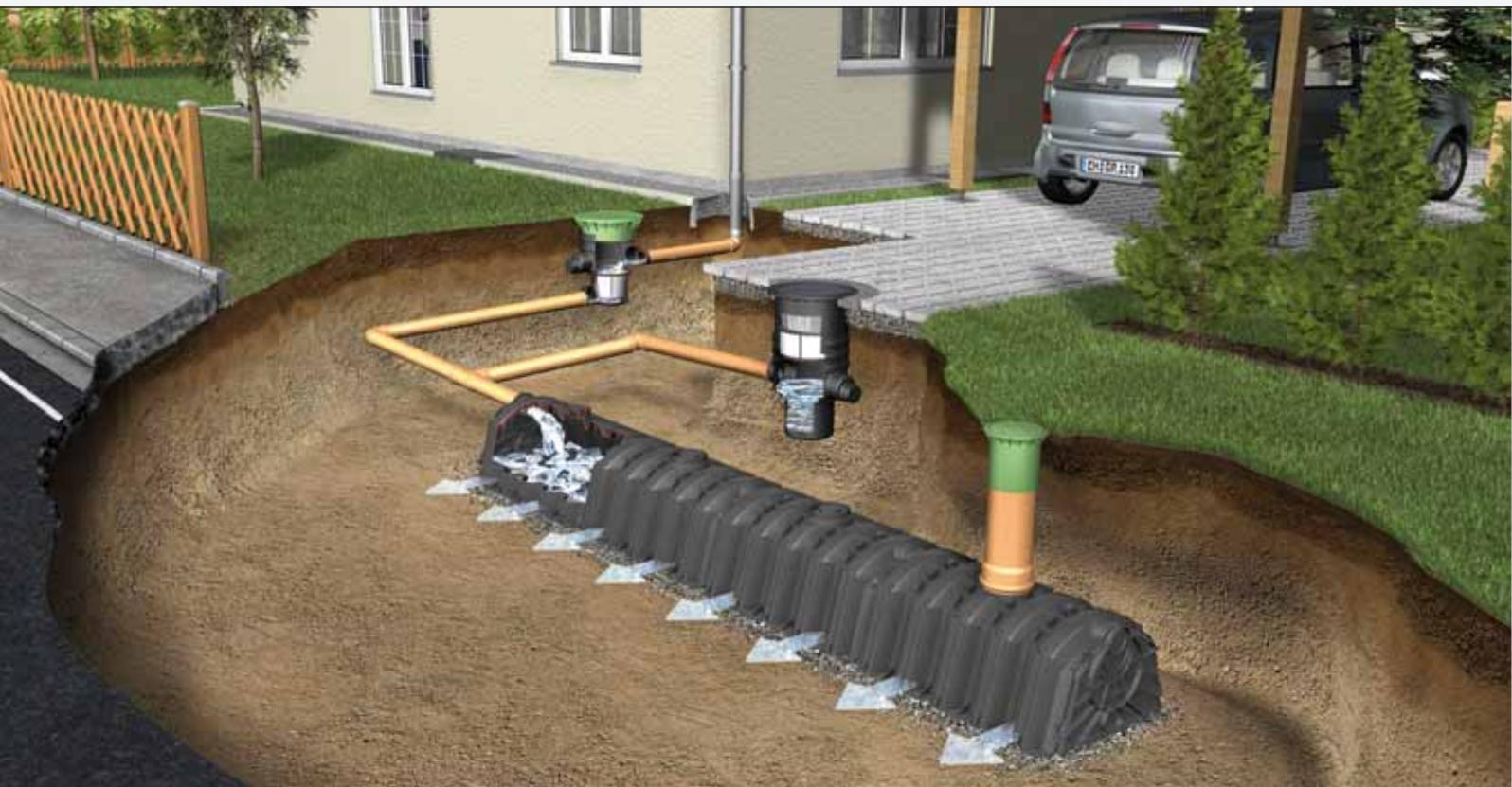
Le tunnel d'épandage GRAF a été conçu pour une utilisation de préférence là où la superficie d'épandage est importante (particuliers, zones rurales...). Le système, composé d'un ou plusieurs tunnels et de deux parois, peut être dimensionné à volonté. L'installation des tunnels se fait en une ou plusieurs rangées sur un même niveau.
