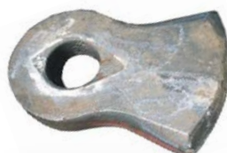
Marteau du broyeur-déchetteur Poids : 115 Kg
