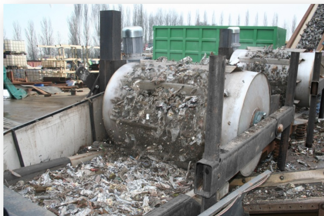
La ferraille broyée est triée par les rouleaux magnétiques
