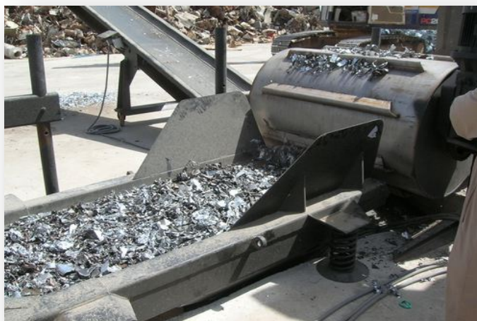
Tri des matières par les rouleaux magnétiques
