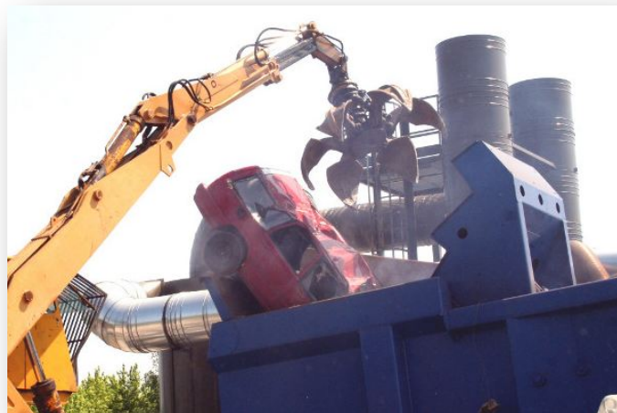
Chargement en vrac d'un VHU avec moteur
