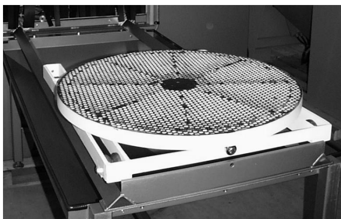
Fig. 7 : Plate-forme de chargement : châssis d'introduction, entonnoir, chariot à plateau tournant
