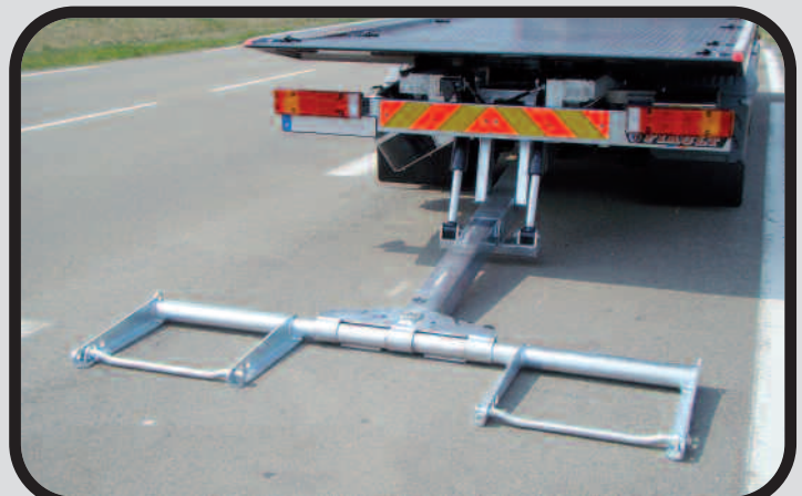
— Fourches de panier galvanisées avec broches coudées réglables — Équipement en série
