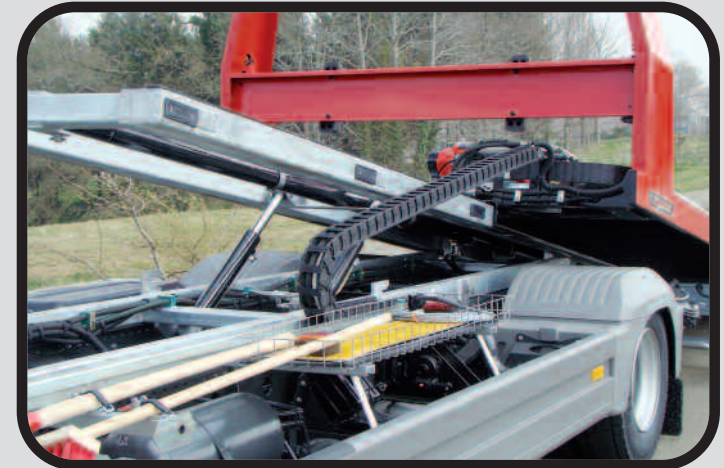
— Galvanisation à chaud du faux châssis et du basculeur
