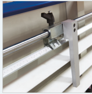
· Butée de réglage de la longueur lors d'une coupe verticale
