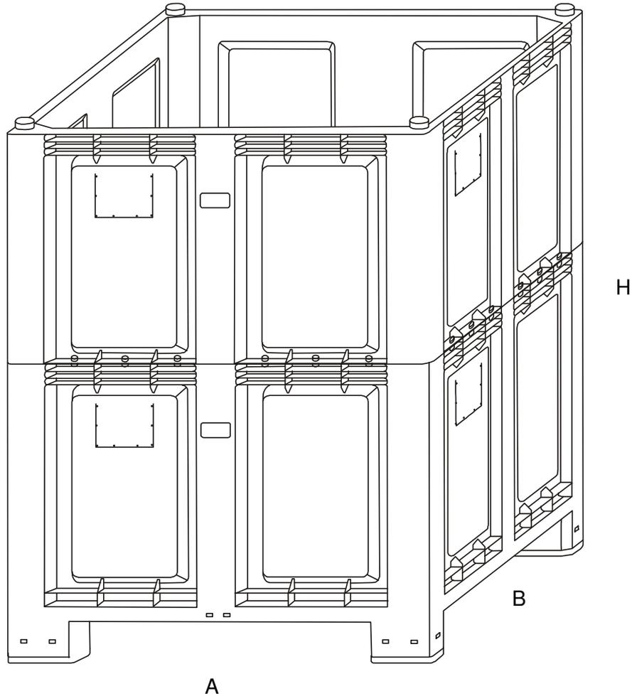
Le **Cargopallet 1300 Plus**, conçue pour déplacer des charges importantes, présente deux avantages essentiels: résistance et indéformabilité, grâce aux cloisons avec colonnes de renfort et fond nervuré. Elle n'est pas adaptée aux liquides. Disponible également pour aliments. Munie de pieds ou de semelles. Capacité max: 1300 dm<sup>3</sup>
