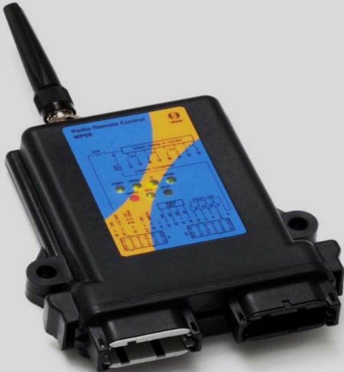
**MP08** Récepteur compact pour applications mobiles à sorties TOR et PWM
