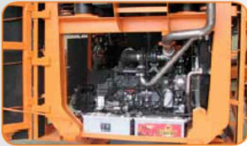
Le système d'entraînement est logé à l'arrière de l'engin dans un compartiment insonorisé.
